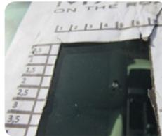
Marcas producidas en la zona A del parabrisas (zona de visión del conductor)
