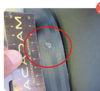
Daños en cinturones
