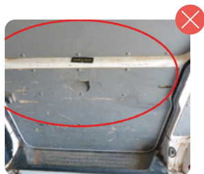
Panel zona de carga roto
