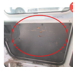
Panel zona de carga roto
