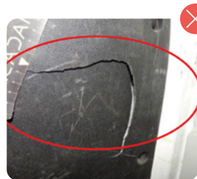
Panel zona de carga roto
