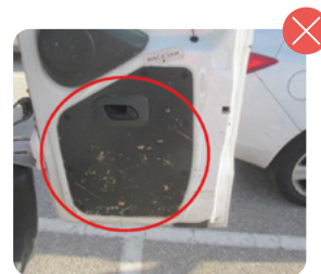
Rayadura panel zona de carga
