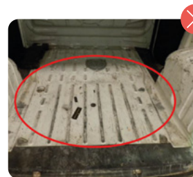
Abolladura y rayado zona de carga
