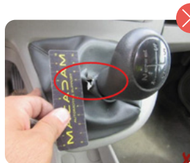
Rotura fuelle palanca
