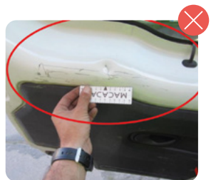
Abolladura zona de carga
