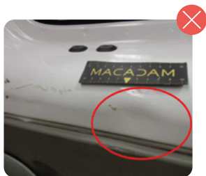
Abolladura zona de carga
