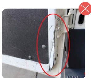
Deformación interior zona de carga
