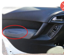
Revestimiento puerta roto
