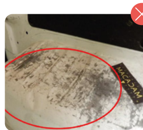
Abolladura y rayado zona de carga
