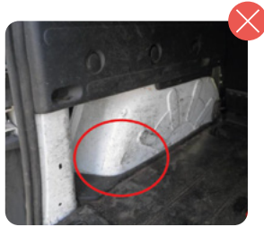
Abolladura zona de carga
