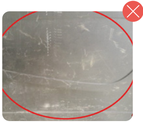
Rayado revestimiento zona de carga
