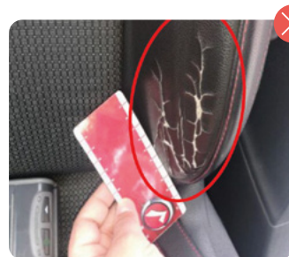
Grietas de cuero
