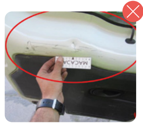
Abolladura zona de carga
