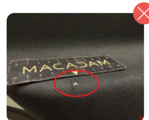
Quemadura revestimiento puerta
