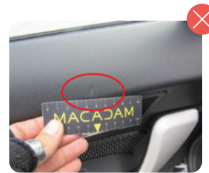
Deformado revestimiento puerta
