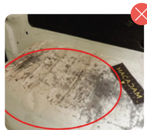
Abolladura y rayado zona de carga
