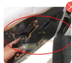
Panel zona de carga roto
