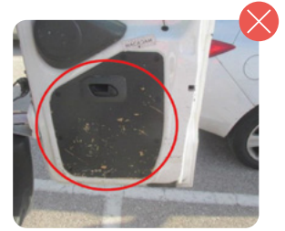
Rayadura panel zona de carga
