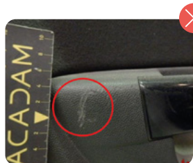
Rayado revestimiento puerta
