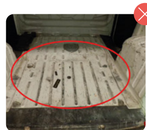
Abolladura y rayado zona de carga
