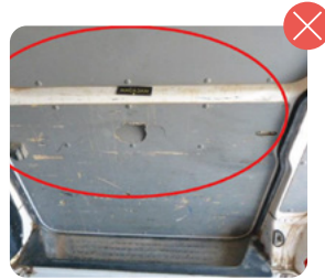
Panel zona de carga roto
