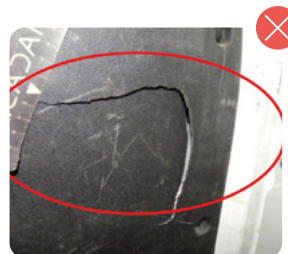
Panel zona de carga roto
