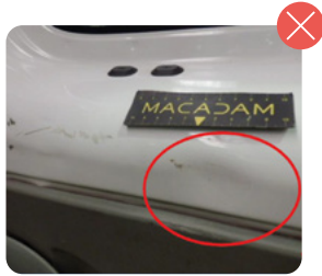
Abolladura zona de carga
