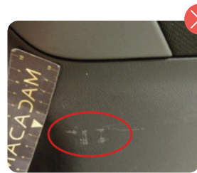
Rayado revestimiento puerta
