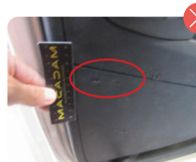
Rayado revestimiento puerta
