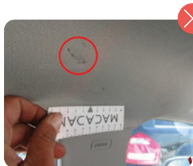
Rotura revestimiento techo
