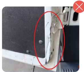
Deformación interior zona de carga
